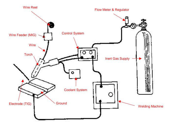
NOTE: MIG = Metal Inert Gas. TIG = Tungsten Inert Gas
